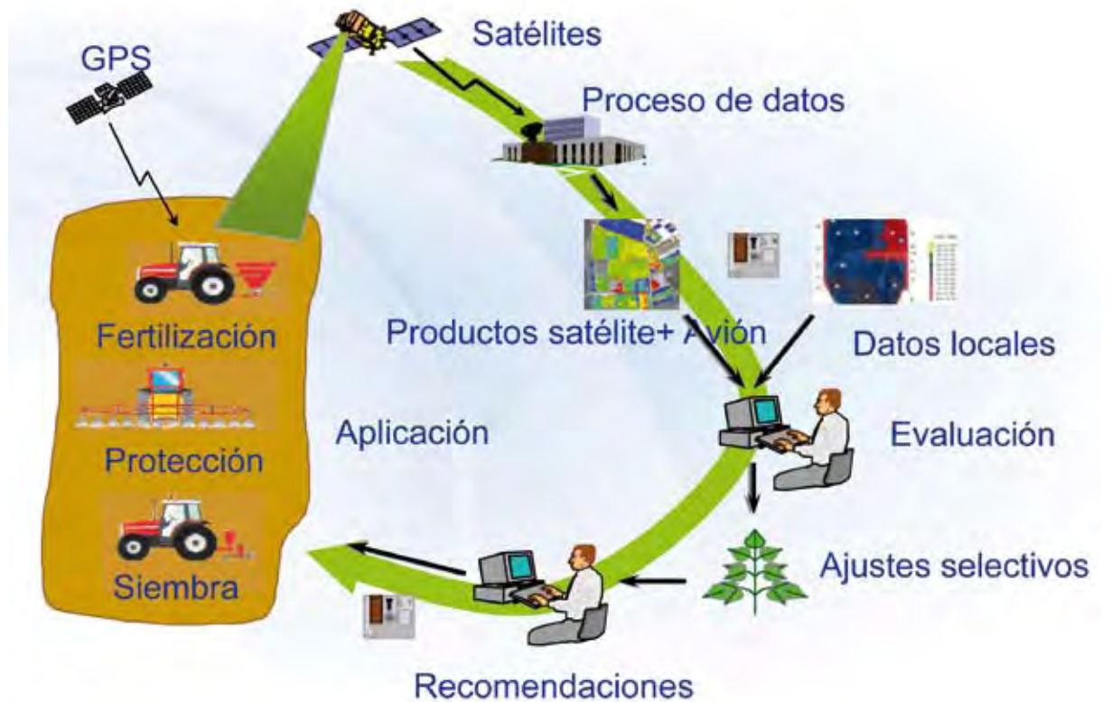
Figura 2. Proceso completo del satélite de teledetección y los conocimientos agronómicos hasta su aplicación incluso con herramientas GPS.
